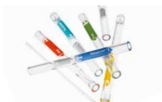
La gama de revestimientos de entrada Trajan SGE tiene como objetivo simplificar la selección del revestimiento correcto para todos los cromatógrafos de gases. Nuestros revestimientos de entrada tienen el nivel más bajo de degradación de Endrin y de degradación de DDT en comparación con los resultados de la competencia. ¿Ya conoce nuestra herramienta de selección de revestimientos? Está disponible en nuestro sitio web para guiarle en la elección del mejor revestimiento para cada aplicación.
