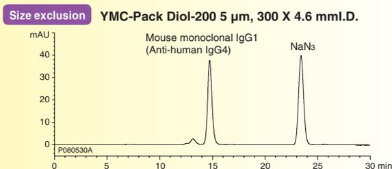
Eluent : 0.1 M  $\text{KH}_2\text{PO}_4$ - $\text{K}_2\text{HPO}_4$  (pH 7.0)
